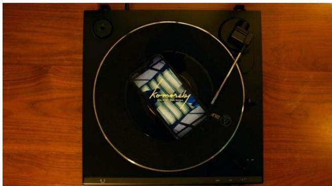
RECORD MUSIC VIDEO（※日本特許出願済）は、アナログレコード盤とスマートフォンを組み合わせることで初めて視聴が可能なミュージックビデオシステムである。動画の再生に特殊なアプリは必要なく、レコードプレイヤーとスマートフォンがあれば誰でもコンテンツを楽しむことができる。33RPM や 45RPM など所定速度で回転するレコードと同速度逆回転する無音映像を制作し、これを回転するレコード上に載置することで初めて映像視聴が可能となる。スマートフォンを載置する際には、市販のレコードスタビライザーを利用。レコードプレーヤーの上から覗き込み、スマートフォンの画面が円形に広がる映像の世界を切り取る、不思議な視聴体験を提供する。本システムの第一弾を「Shin Sakiura / komorebi feat.BASI」の7インチレコードに提供、ソーシャルホテル HOTEL SHE, OSAKA と連動しフロントでの貸出や販売を行った。また、若手アーティストに過去の名盤レコードに MV を開発することにより、昔のレコードの再発掘プロジェクトにも利用されている。
